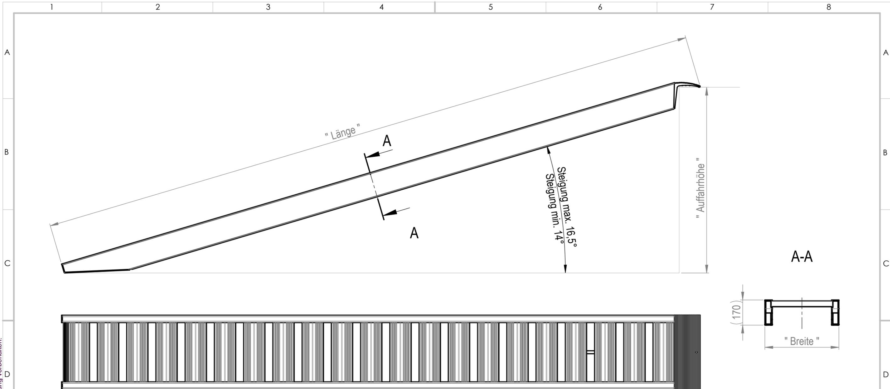
\*Die Tragkraftangaben gelten pro Paar und beziehen sich auf ein zweiachsiges Fahrzeug mit einem Achsabstand von 1500 mm und einer gleichmässigen Lastverteilung (50% zu 50%).
